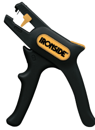
PELACABLES AUTOMÀTIC 9681419 Fil i cable de 0,2 a 6,0 mm². Topall de longitud entre 5 i 12 mm. Fulla de tall lateral Ø fins a 2 mm. 22'95
